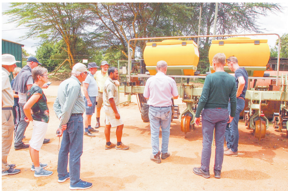
■ Denne StripTill såmaskine kan også placere gødning. Den havde de stor succes med, fordi den kun bearbejder en stribe og derved bevarer mest mulig fugt i jorden.
