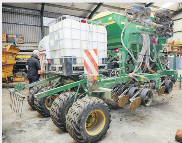
■ John Deere fremstiller i USA denne direkte såmaskine, som er populær hos mange CA-landmænd såvel internationalt som i Danmark. Her i maskinhallen hos Norman Dunne.
